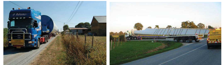
Photo 126 : le transport des éléments d'une éolienne
